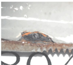
赤錆を黒錆に変え管厚を復元する
